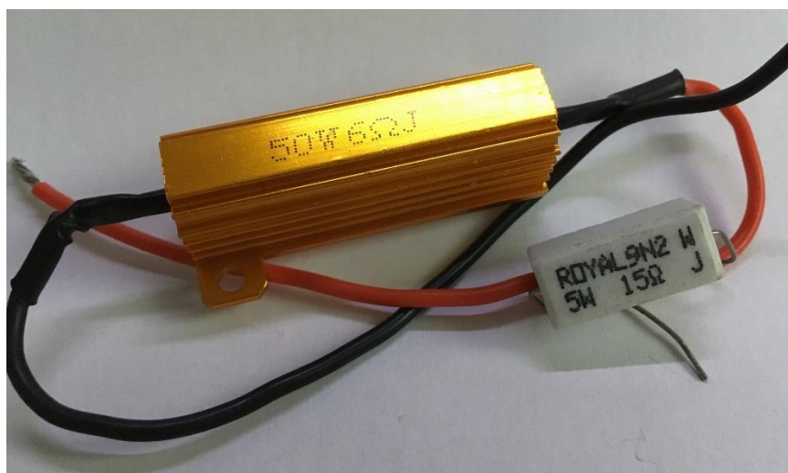
Obrázek 13 – Rozdíl obalů výkonových rezistorů – oranžový 50W, bílý 5W
